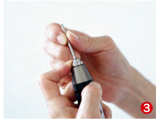
SPモータードライバーの先端に、SPモータードライバービットを装着します。
