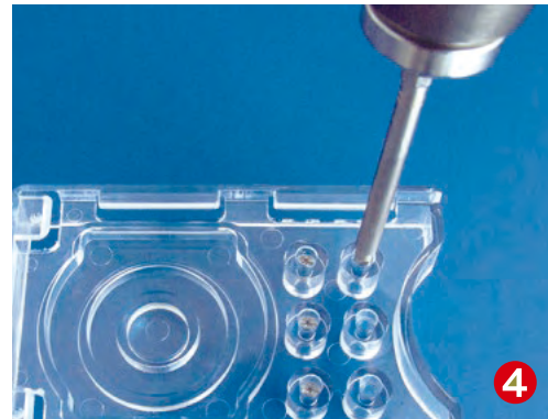
SPモータードライバーの先端に、SPモータードライバービットを装着します。
